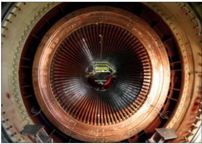
Le moindre défaut d'isolement d'une des 168 barres du stator entraîne l'arrêt automatique de la centrale. Photo archives Pierre HECKLER.
